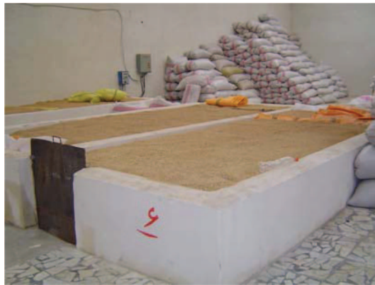
شکل ۶۳ - نمونه‌ای از خشک‌کن بستر خوابیده ساخته شده از مصالح ساختمانی
