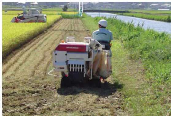
شکل ۴۲ - کمباین هدفید نوع سوارشونده - راه رونده (مجموعه‌ای از اهرم‌های کنترل ماشین در قسمت جلو و مجموعه‌ای دیگر در قسمت پشت سر اپراتور تعبیه گردیده است).
