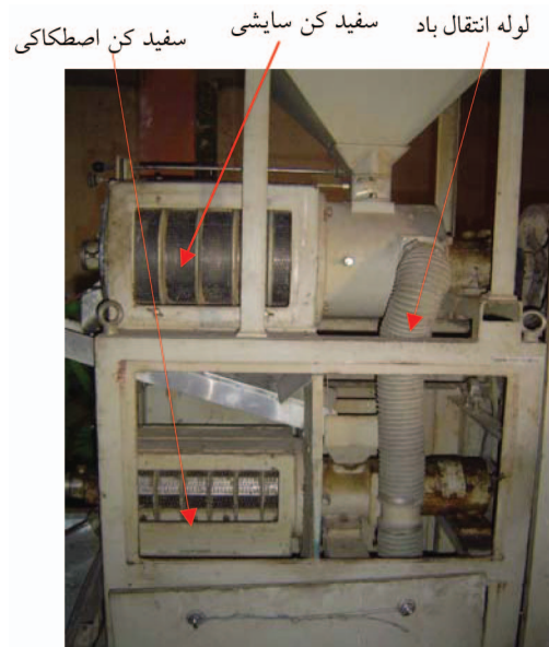
شکل ۸۳- تصویری از یک سفیدکن ترکیبی (سایشی و اصطکاکی) مجهز به سیستم باد
