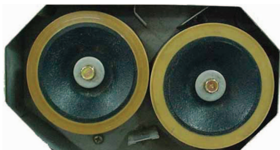
شکل ۷۳ - پوست‌کن نوع غلتک لاستیکی
