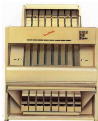
شکل ۹۲ - نمونه‌ای از یک دستگاه درجه‌بندی کننده بر اساس رنگ (ساخت شرکت ساتاکه)
