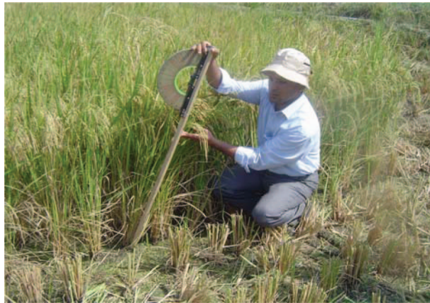
شکل ۴۰- نحوه‌ی تعیین میزان خوابیدگی گیاه
