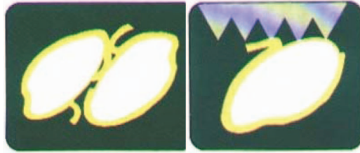
شکل ۷۹ - سفیدکنی برنج بر اساس اصطکاک داخلی بین دانه‌ها (چپ) و ساییده شدن در اثر تماس با اجسام ساینده (راست)
