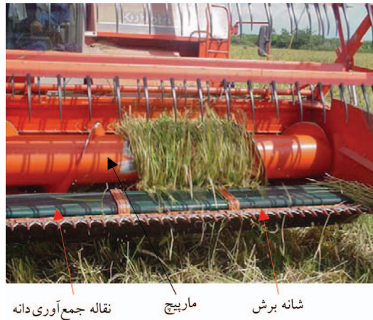
شکل ۲۹- اجزای دماغه کمباین استاندارد برنج
