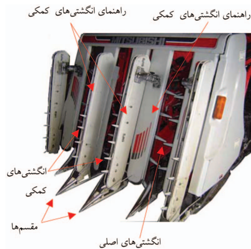
شکل ۴۱- اجزای مختلف واحد دروکننده (دماغه) کمباین هدفید
