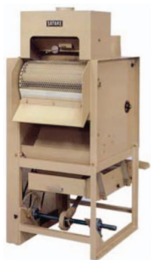
شکل ۶۷- نمونه‌ای از پیش بوجار متشکل از الک مرتعش، سنگ‌گیر و سیستم باد (مکنده)
