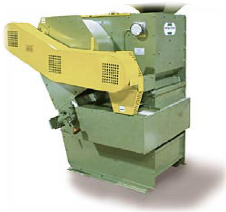
شکل ۱-۲۳. مکانیسم عمل سنگ گیر
